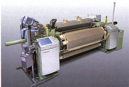
Abb. 4: DOB-Gewebe auf einer Greiferwebmaschine Typ PTS8/S 20 C in 190 cm MNB
