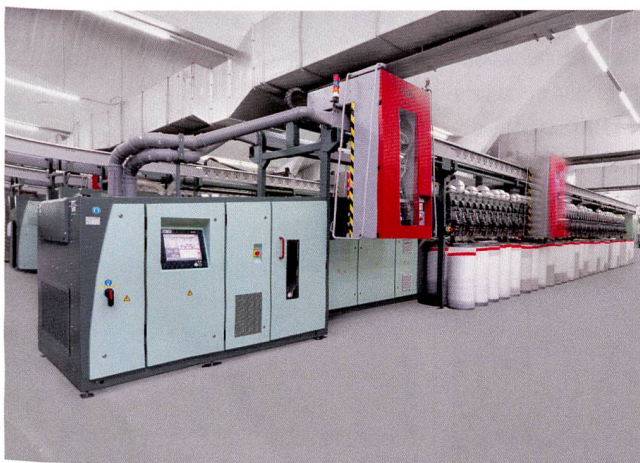
Abb. 2: Die Luftspinnmaschine J 20 mit bis zu 120 hochproduktiven Spinnheiten
