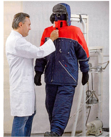
Abb. 3: Kein Nässegefühl mehr – optimierte Wärmeschutzkleidung wird an den Hohenstein Instituten mit Hilfe der Testpuppe «Charlie» getestet. ©Hohenstein Institute
