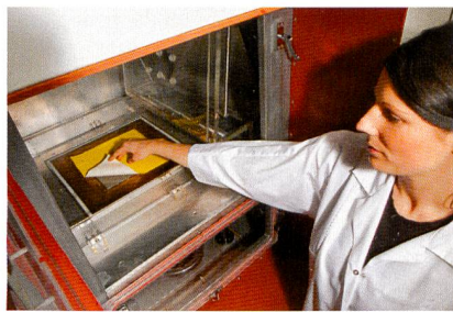
Abb. 4: Um das Wärme- und Feuchtemanagement der Funktionsmuster zu ermitteln, die aus dem neuartigen Garn produziert wurden, nutzen die Hohenstein Wissenschaftler das Hautmodell. ©Hohenstein Institute
