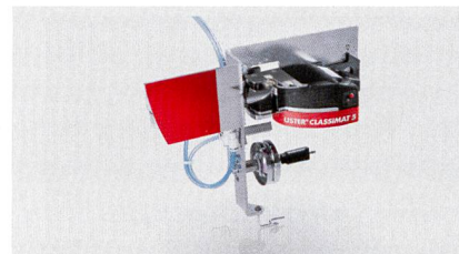
Abb. 2: USTER® CLASSIMAT 5 Messkopf am Befestigungsmodul
