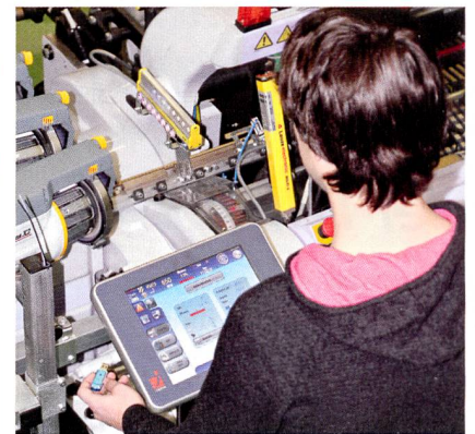
Abb. 2: Der Touch-Screen erlaubt dem Weber und dem Techniker die Silver 501 sehr einfach zu bedienen
