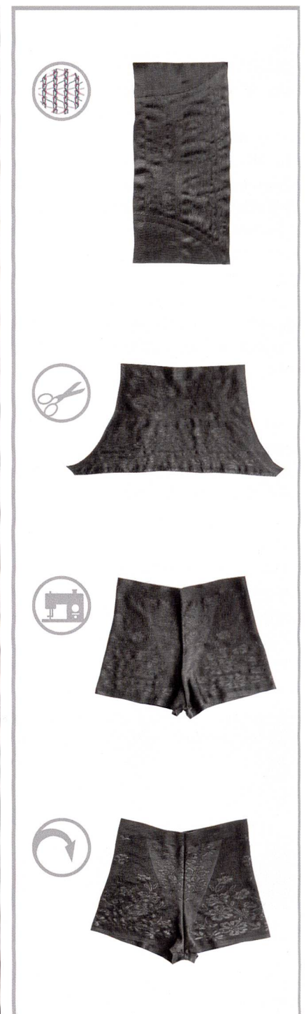
Abb. 3: Die Arbeitsschritte zur Herstellung der 3D-Shape-Höschen
