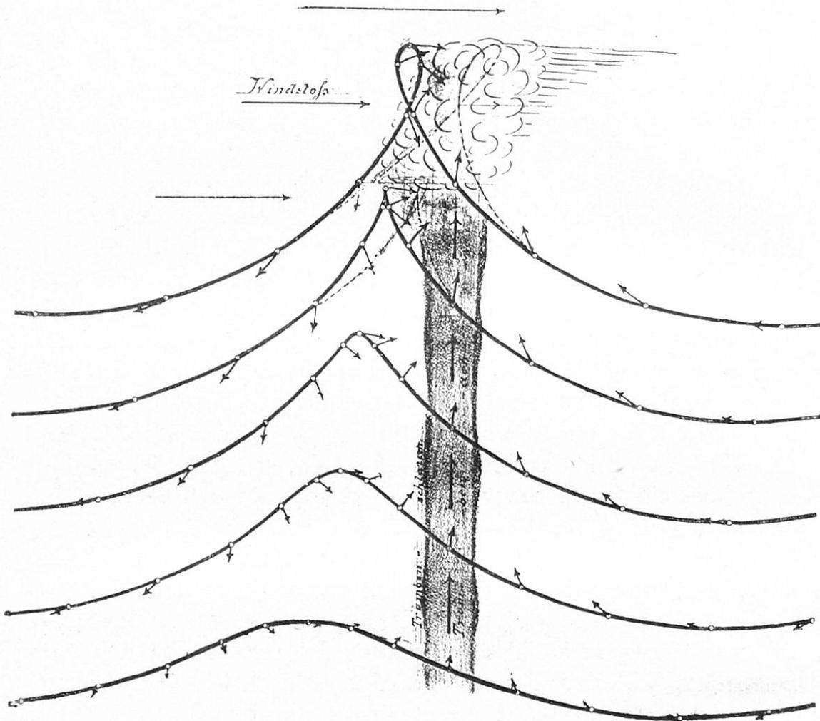
Fig. 2. Schema einer wogenden Luftschicht mit Sturmkräuse und Vertikalstrom. Die eingezeichneten Pfeile sind die momentanen Geschwindigkeiten der Luftteilchen an den betreffenden Stellen.
