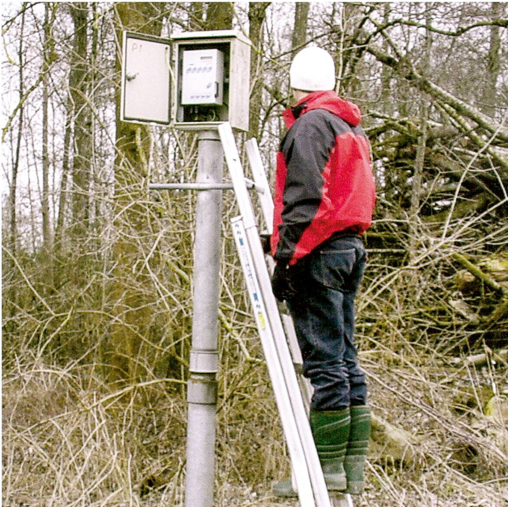
Abbildung 7: Hohes Überstandrohr mit installierter automatischer Aufzeichnung.
