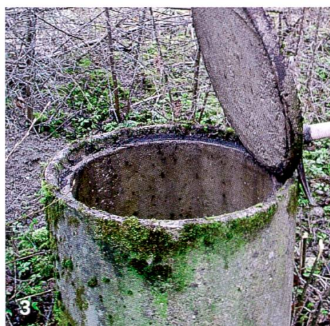
Abbildung 3: Grundwasser-Messrohre in Schächten: 1: Kleiner Schacht, nach längerer Suche im Wald ausgegraben. 2: Mittliger Schacht, ebenerdig, von Gras überwachsen und frisch ausgegraben. 3: Überstehender Schacht mit grossem Durchmesser.
