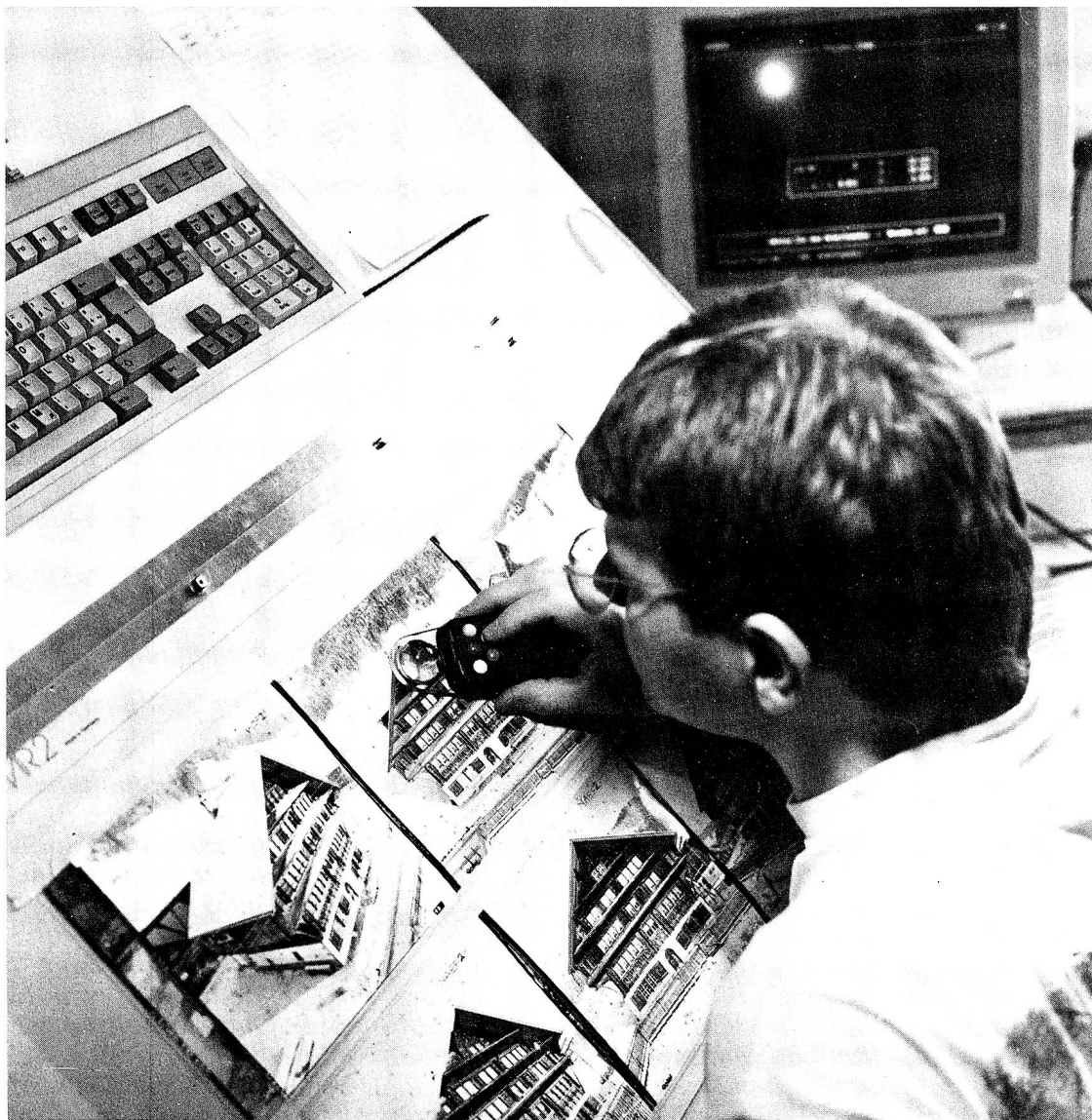
Mann am Computer. Auswertung der Bilder am Computer. Mit dem Messlupensensor werden die Messkreuze eingelesen. Automatisch entsteht eine dreidimensionale Darstellung des Hauses.
