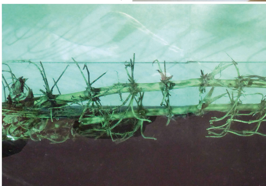
Dettaglio, radici di bambù lunghe 5 metri, che si sono estese per anni in maniera incontrollata all'interno di un tubo. ↓
