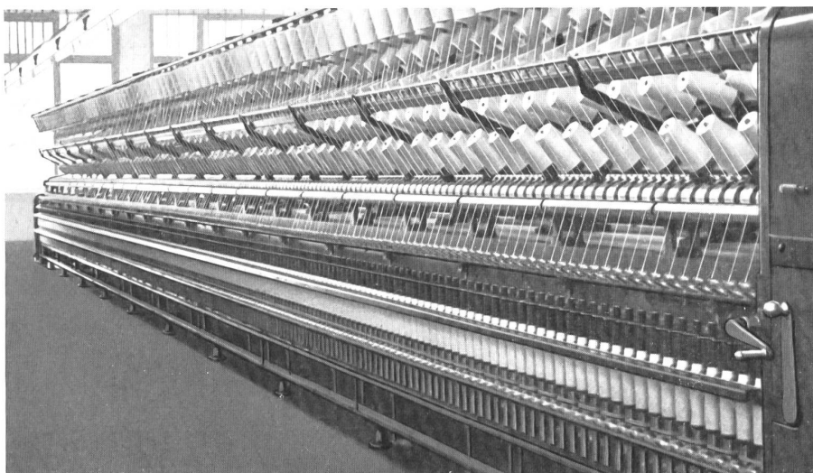
Generalansicht einer Baumwoll-Ringzwirnmachine. Bäumlin, Ernst & Co., St-Gallen.
