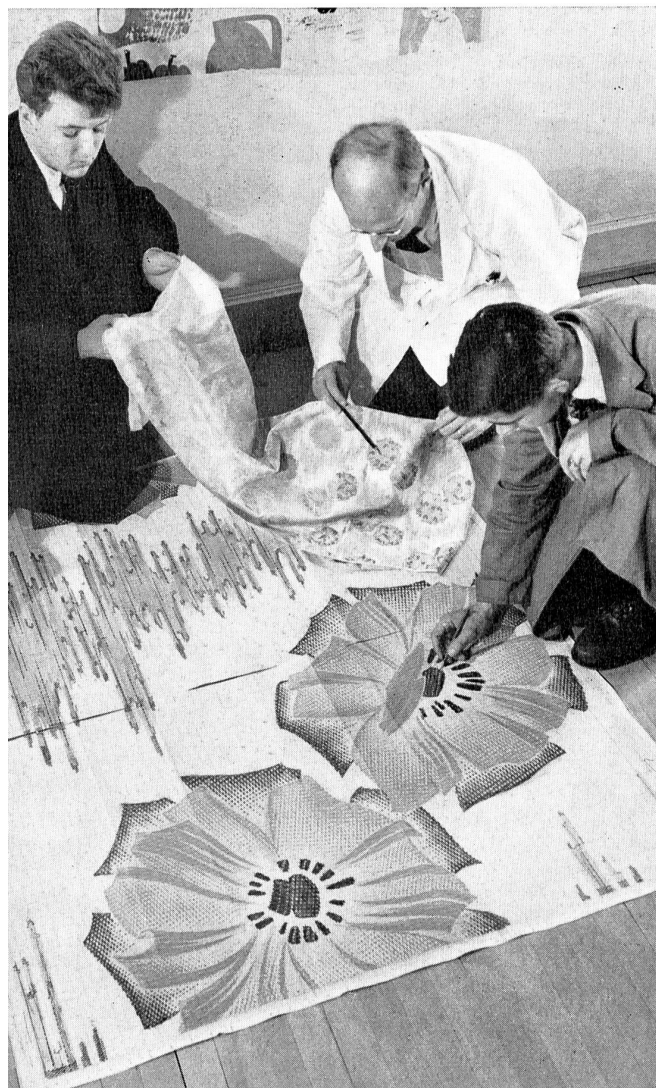
Prüfung eines Jacquard-Gewebes auf Grund der Patrone.
