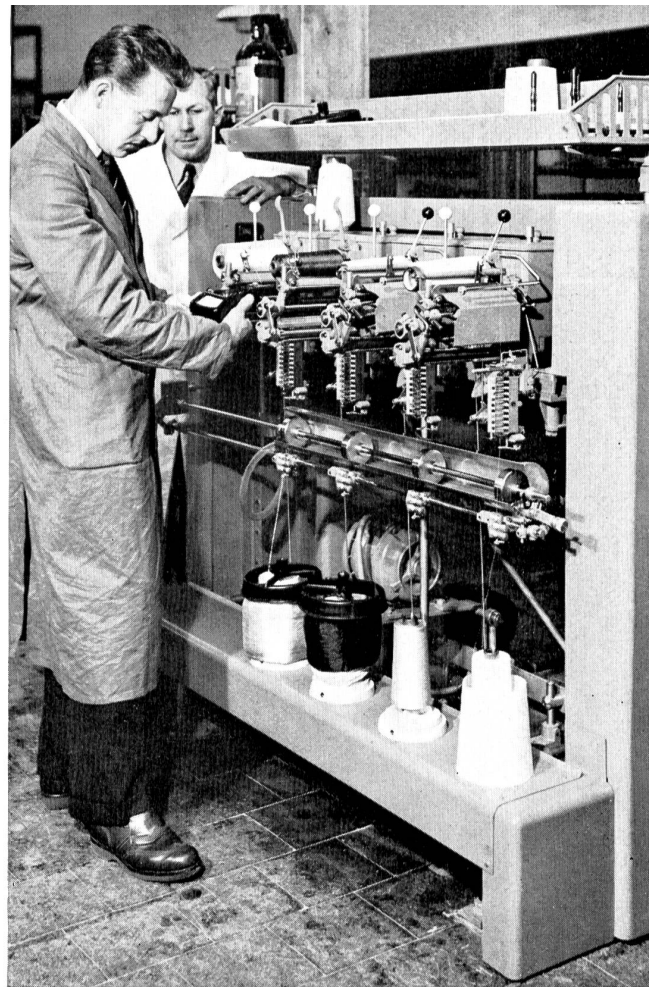
Kontrollarbeit an einer Kreuzspulmaschine.
