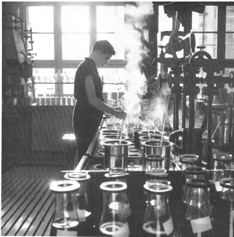
Département des teintures : examen de solidité. Dyes department : fast color testing. Departamento de las tinturas : prueba de solidez. Coloristisches Department : Prüfung der Echtheiten.
