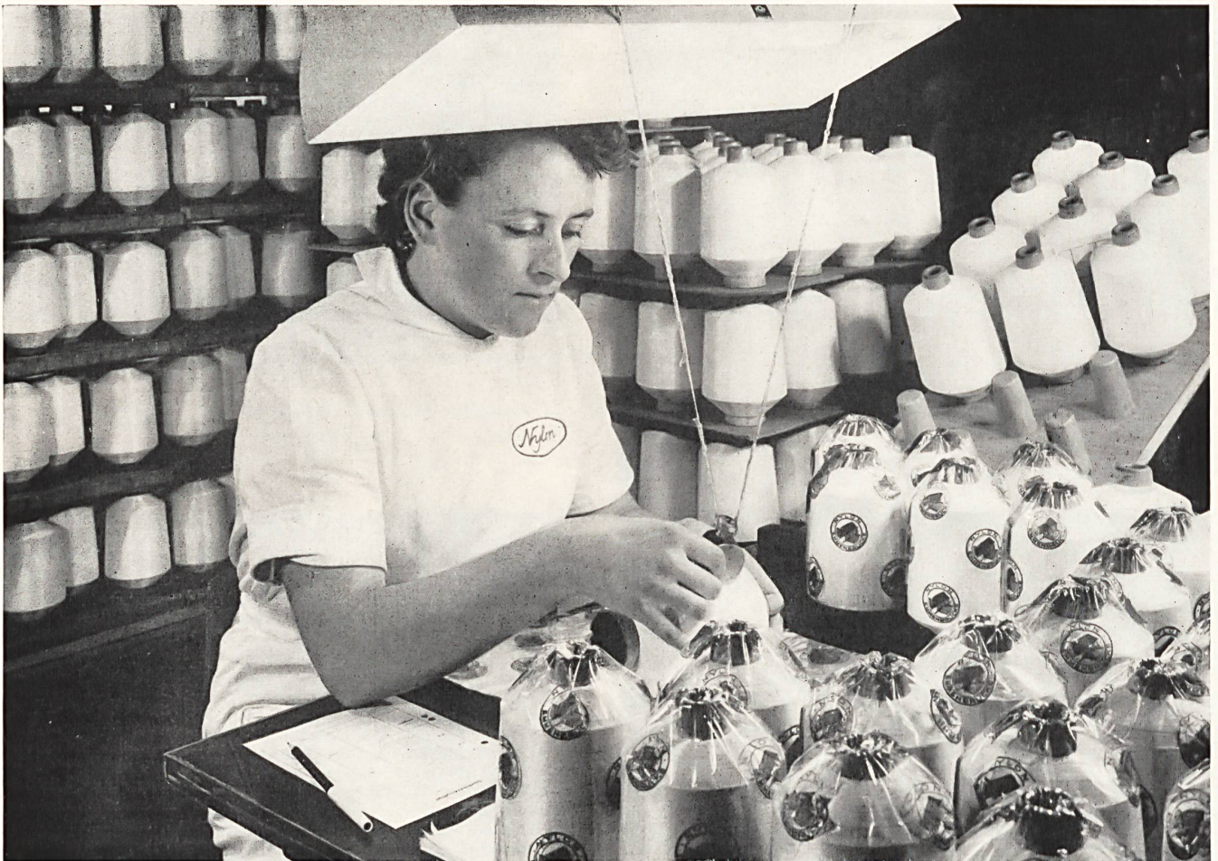
Kontrolle und Verpackung des Nylon «Nylsuisse»; die Konen werden sowohl auf Härte wie auf Sauberkeit geprüft. Nur den strengen Normen entsprechende Konen werden für die Herstellung von Artikeln verwendet, die das Recht haben die Qualitätsmarke «Nylsuisse» zu tragen
