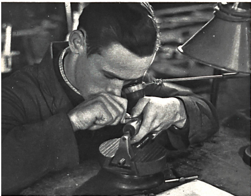
Gravure à la main, en relief, d'une molette d'acier qui servira à reporter en creux le motif gravé sur un cylindre de cuivre, pour l'impression au « rouleau ».
