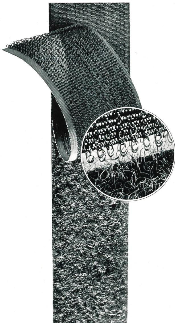
La fermeture Velcro se compose de deux rubans en nylon.
