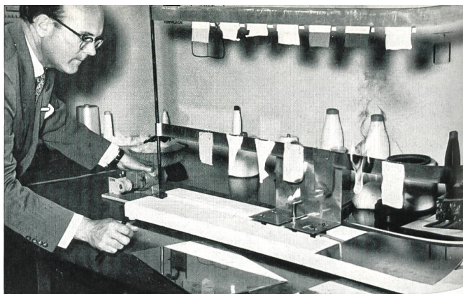
Démonstration de l'inflammabilité de divers échantillons textiles.
