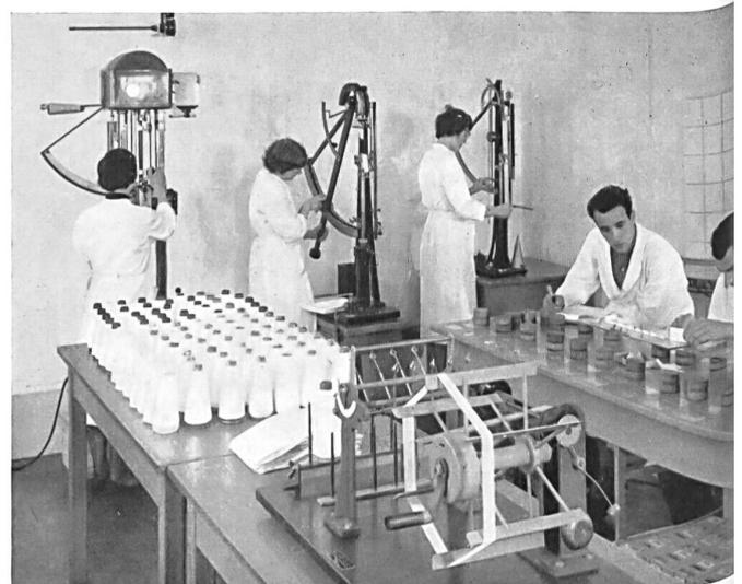
Laboratoire de contrôle des filés « Hélanca » et des articles confectionnés avec ce fil
