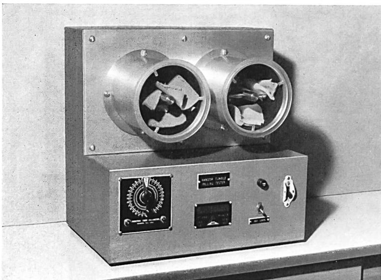
Appareil servant à contrôler la tendance au boulochage d'un tissu en filé « Héalanca »
