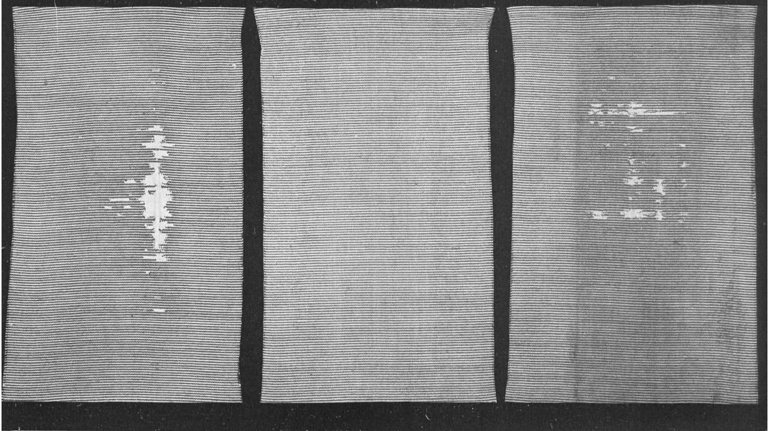
*Essais de résistance de la fibranne — Staple fibre after abrasion tests
