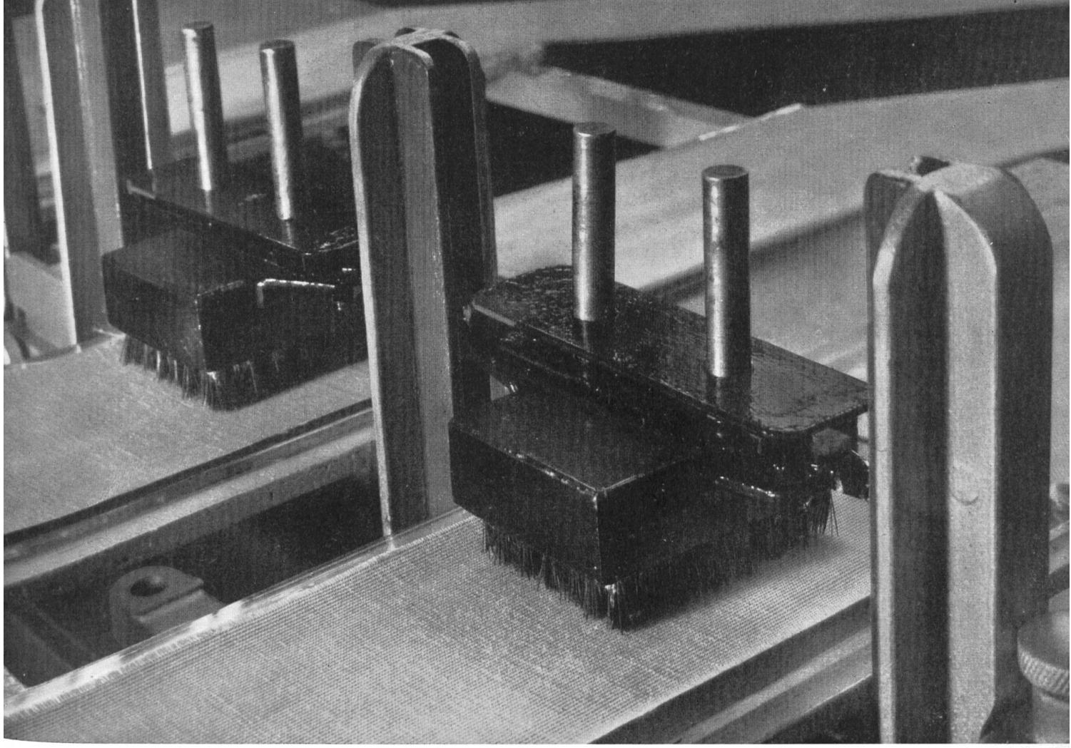
*Appareil pour contrôler l'usure des tissus. — Brush-Test Apparatus. — Aparato para comprobar la resistencia a desgaste de los tejidos.
