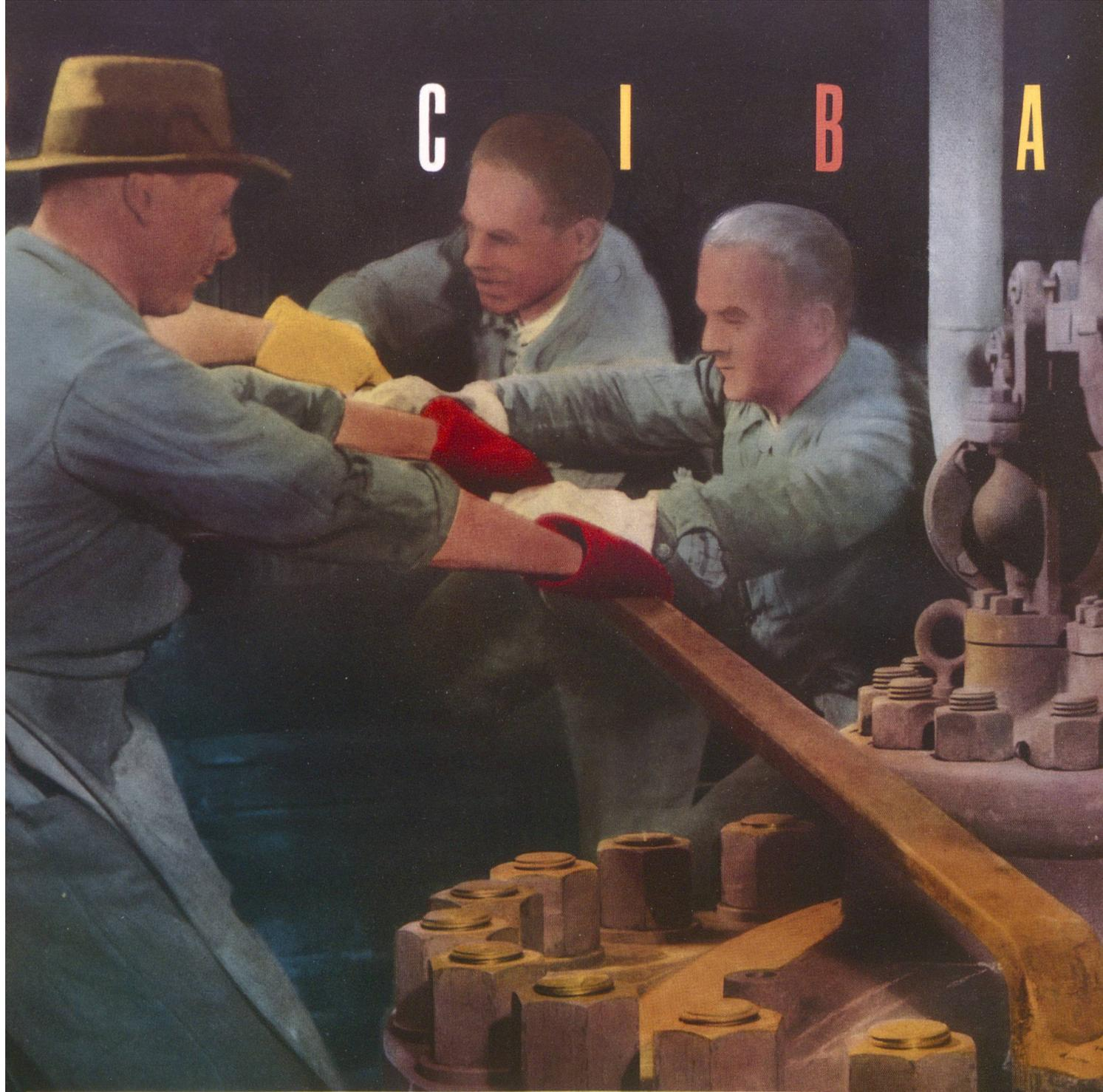
Lo que el hombre de Ciencia sintetiza con ayuda de sutiles métodos de laboratorio, es trabajado industrialmente en enormes recipientes a presión. Calderas de doble tabique, provistas de aparatos de agitación, unas calentadas con vapor y otras refrigeradas con agua, son cargadas con las materias primas y termómetro y manómetro señalan el curso de la operación química.
