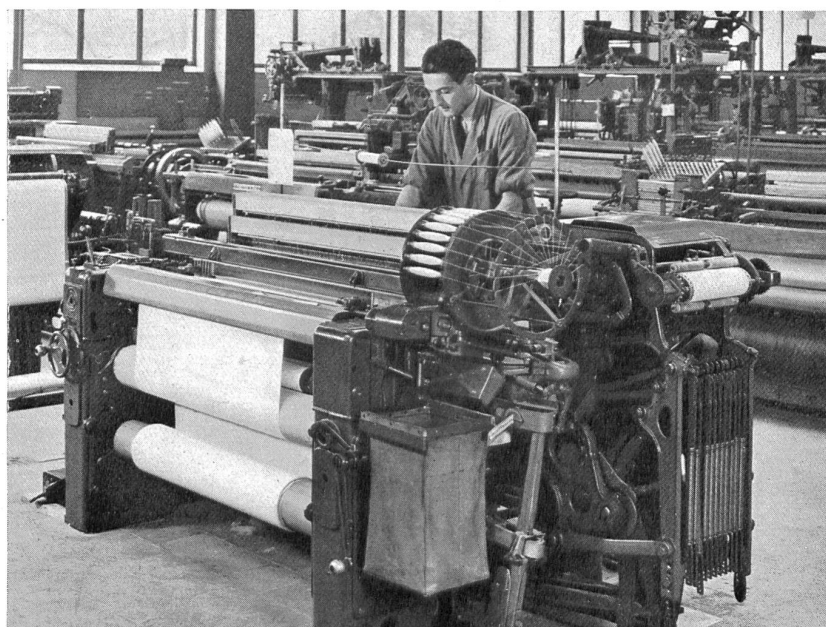
Un moderno telar con ratiere y con cambiador de canillas, en la escuela de Zurich.
