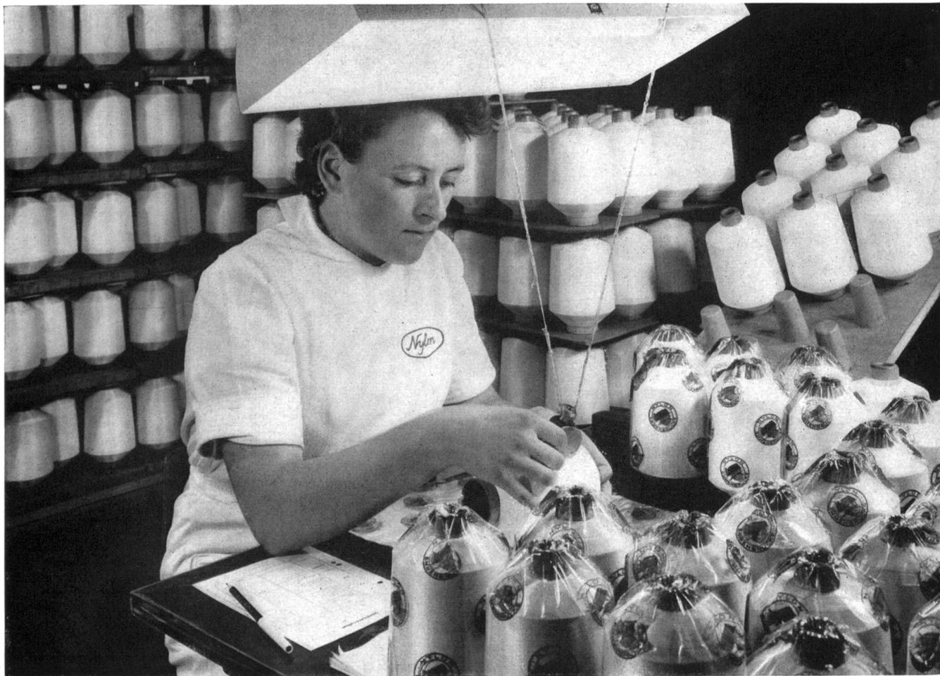
Verificación y embalaje de los conos de nylon «Nylsuisse»: el examen de su dureza permite comprobar si han sido devanados con la tensión correcta, ni demasiado floja, ni demasiado fuerte. Únicamente los conos que cumplen unos requisitos muy severos pueden ser utilizados para la fabricación de textiles que ostenten la marca «Nylsuisse»
