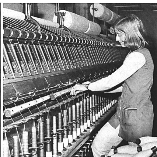
Ringspinnmaschine in der Streichgarnspinnerei. Métier à filer à anneau dans la filature de cardé. Ring-spinning machine in the carded yarn spinning mill.
