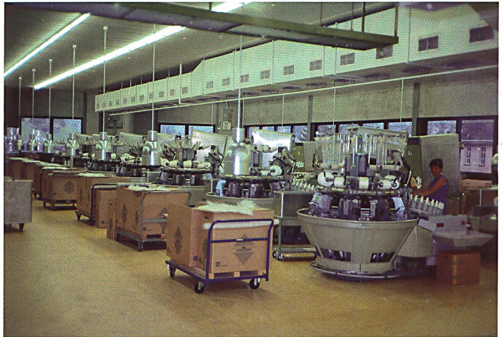
Spulerei-Abteilung mit Schweizer CA11 Maschinen / Section de canetage, machines Schweizer CA11 / Winding section with Schweiter CA11 machines.
