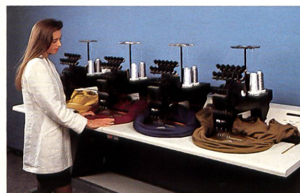
EMC6/4 = 4 Kopf, 6 Nadeln Stickmaschine
