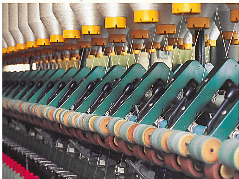
Ringspinnmaschine für Flammengarn
