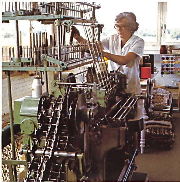
Häkelmaschine. Das Dessin wird durch die lange Kette gesteuert. Machine à crocheter. Le dessin est commandé par la longue chaîne. Crocheting machine. The pattern is controlled by the long chain. Macchina per il lavoro all'uncinetto. Il disegno è diretto dalla lunga catena.
