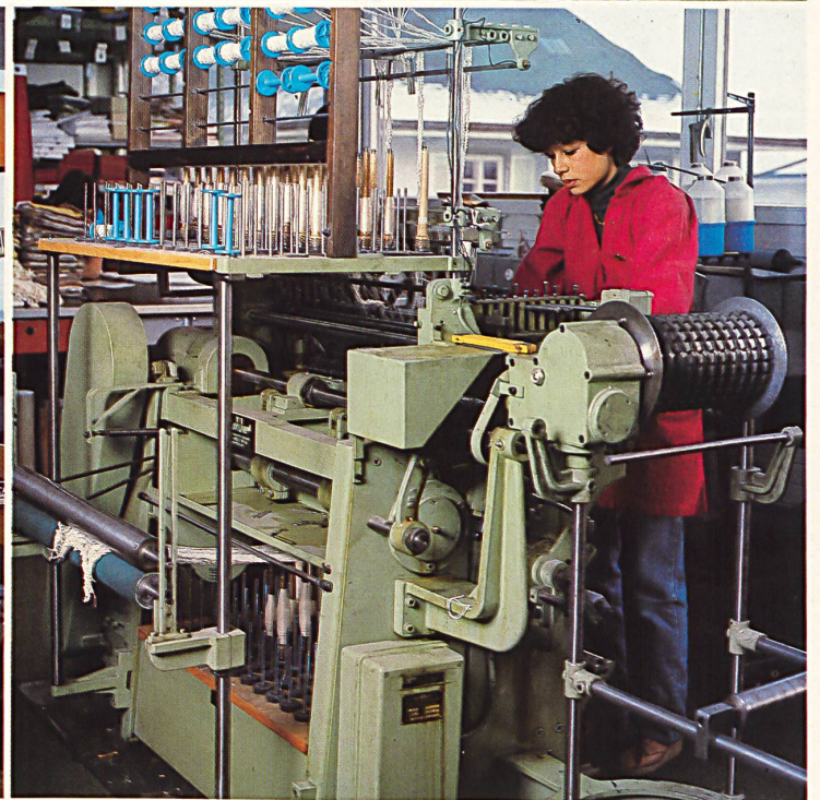
Mustermaschine zur Entwicklung von Häkeldessins / Machine à échantillonner pour la recherche de dessins au crochet / Machine for making up patterns for crocheted designs / Macchina da modelli, per la creazione di disegni all'uncinetto.
