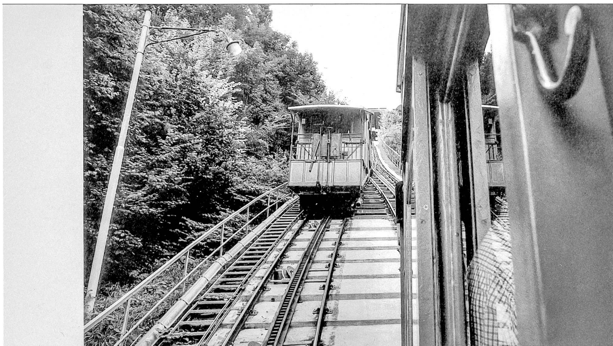
Croisement terminé: la voiture lestée d'eaux usées file à 4 km/h vers la station inférieure entraînant par contrepoids le véhicule opposé
