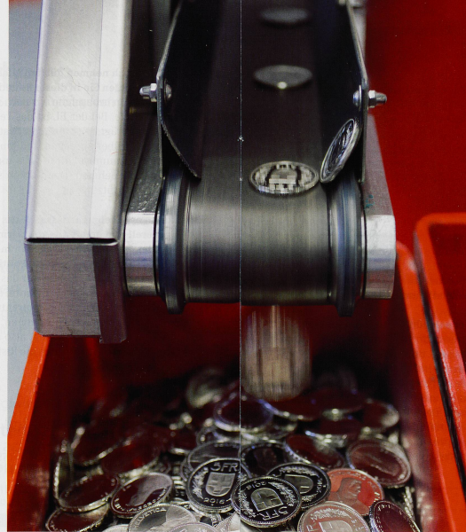
Die Prägemaschine spuckt pro Minute rund 130 Nominale (zum Beispiel 5 Rappen) sind bis zu
