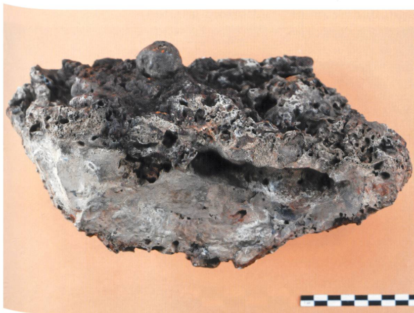
Abb. 20 Bruchstück einer Eisenerzverhüttungs- schlacke.
