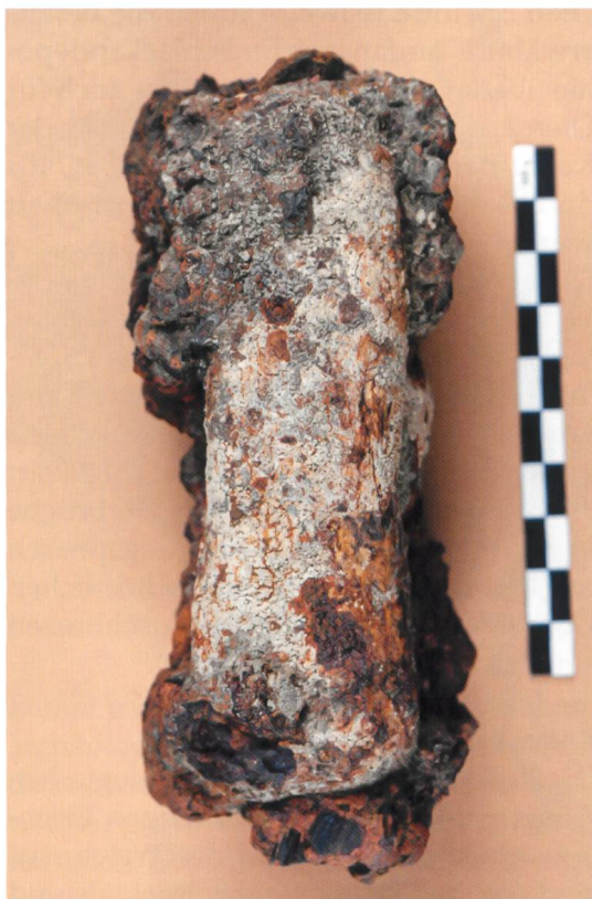
Abb. 20 Bruchstück einer Eisenerzverhüttungs- schlacke.
