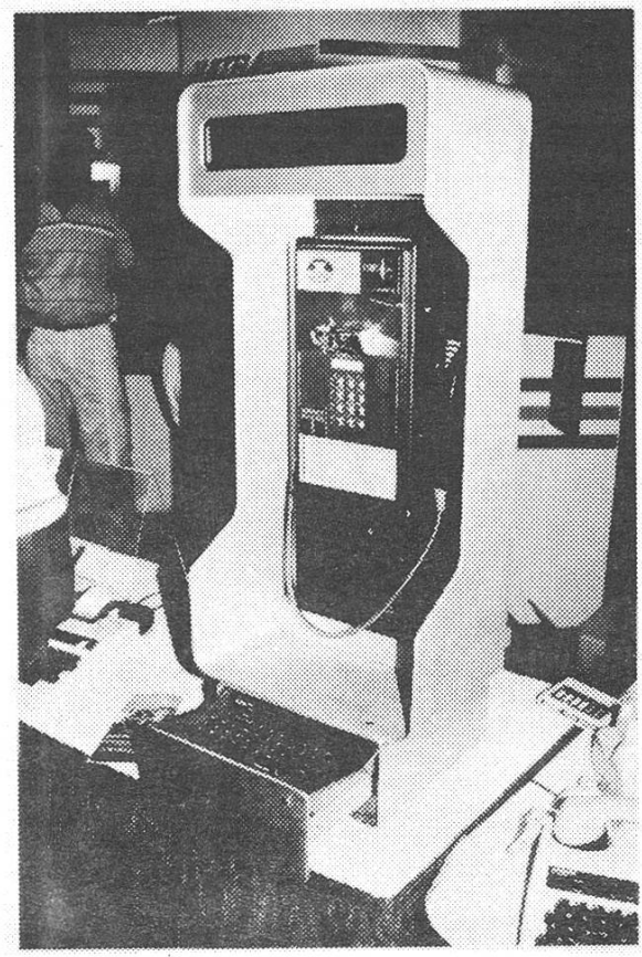
Ausstellung Technologie: Öffentliches Telefon mit eingebauten Schreibtelefon - benützbar für Hörende und Gehörlose
