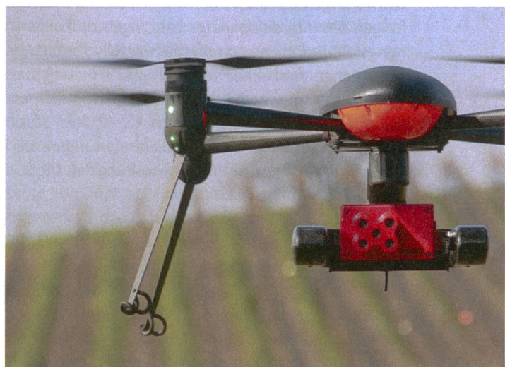
Drohne mit Hyperspektralkamera zur Früherkennung von pilzlichen Erkrankungen von Reben. Bild: ZHAW
