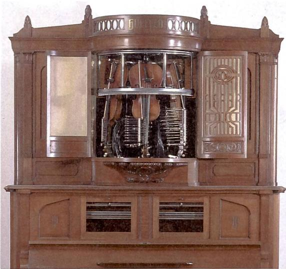
**Abb. 5.** Phonoliszt-Violine (1908). Der nach wie vor betriebsfähige Violinautomat der Firma Ludwig Hupfeld AG, Leipzig, besteht aus einem Klavier und drei sich drehenden Geigen. Die Steuerung erfolgt über eine Papiernote Rolle (© Technisches Museum Wien).
