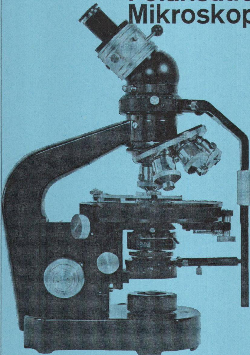
Für polarisationsoptische Untersuchungen und Messungen in durchfallendem Licht, sowohl im orthoskopischen als auch im konoskopischen Strahlengang. Mit 6-fachem Objektivrevolver, Schnellwechselfassung für Objektive, binokularem Schrägtubus sowie synchroner Drehvorrichtung lieferbar. Ausführliche Beschreibung im Prospekt M 1 105
