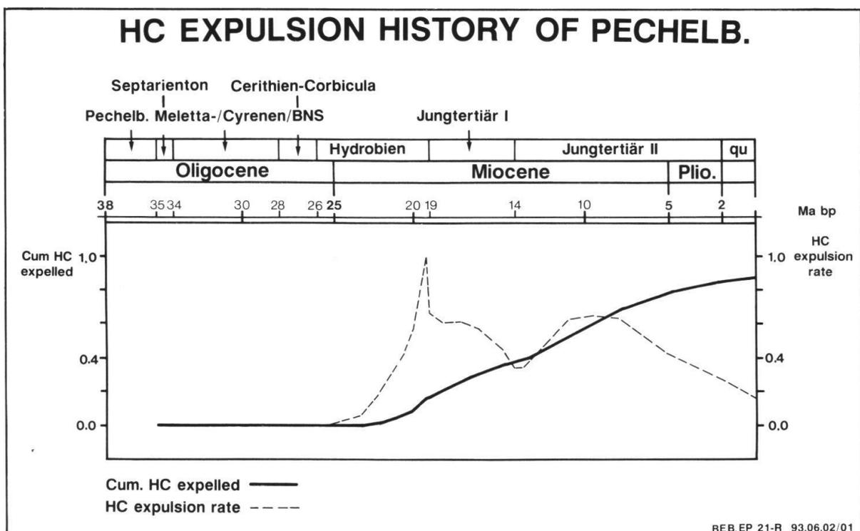
**Fig. 9:** Simulation der Kohlenwasserstoffabgabe der mittleren Pechelbronn Schichten und des Septarientons. Die KW-Expulsionsrate und die kumulative KW-Expulsion sind auf ein Maximum normiert.
