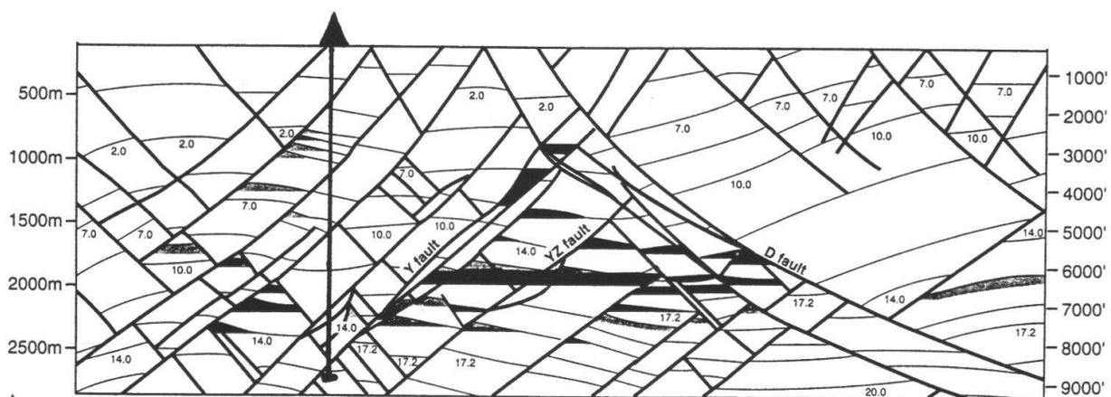
**Figur 5:** Ein Beispiel aus der «real world»: Wie eine Bohrung eine Vielzahl von Erdöl- und Erdgas-Akkumulationen trotz allem verfehlen kann.
