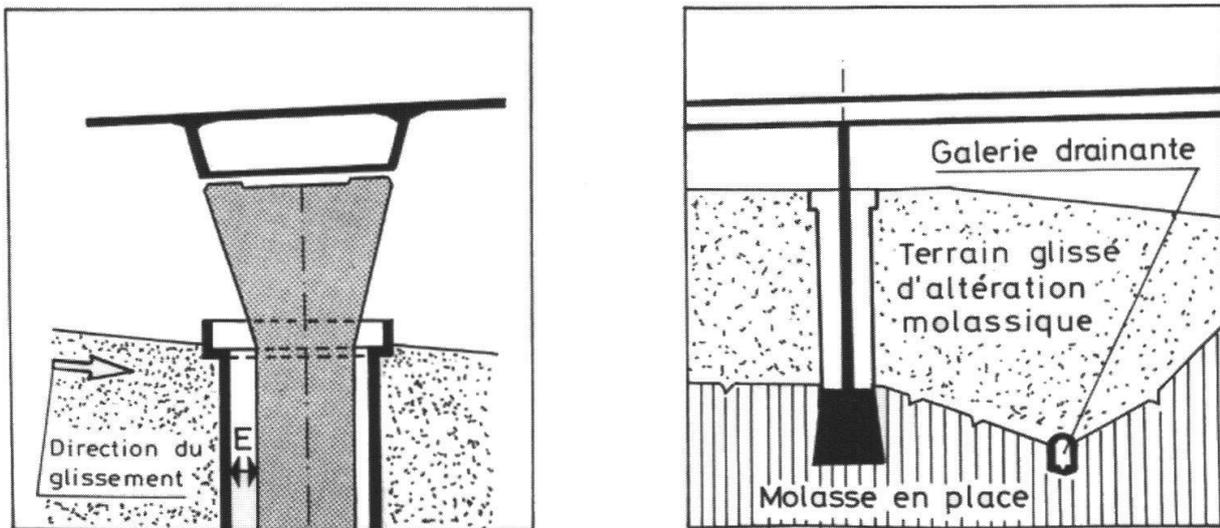
**Fig. 4:** piles chemisées dans les puits de fondation du pont; l'espace E permet un éventuel déplacement du glissement sans mettre en péril gravement l'ouvrage (d'après documentation du Bureau des autoroutes du canton de Vaud).
