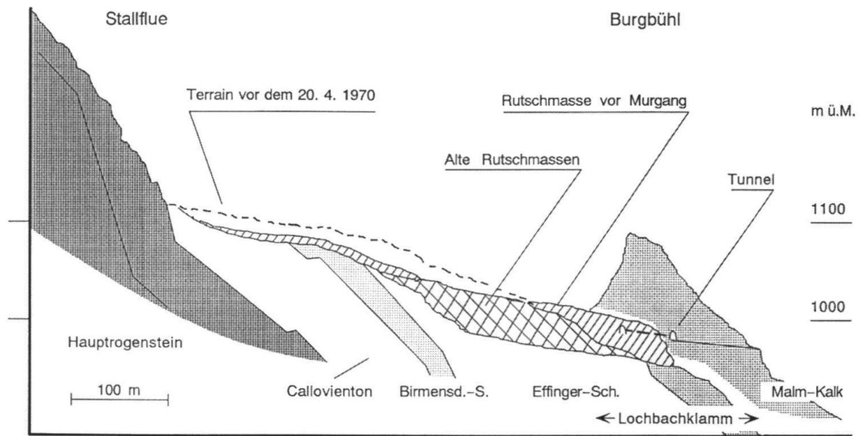
**Fig. 4:** Vereinfachtes Querprofil durch das Abriss- und Ablagerungsgebiet des Rutsches von Schauenburgschwang nach Fröhlicher, Bericht 1971 (verändert). Die Rutschmasse ist in ihrer Position in und vor der Lochbachklamm eingezeichnet. Aus dieser Masse löste sich der Murgang von Selzach.
