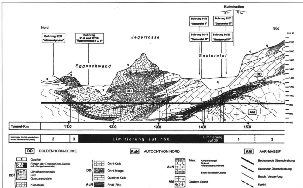
**Fig. 8:** Ausschnitt aus dem geologischen Prognoseprofil des Lötschberg-Basistunnels mit den einzuhaltenden Limiten der Abdrainage (aus Kellerhals & Isler 1998)
