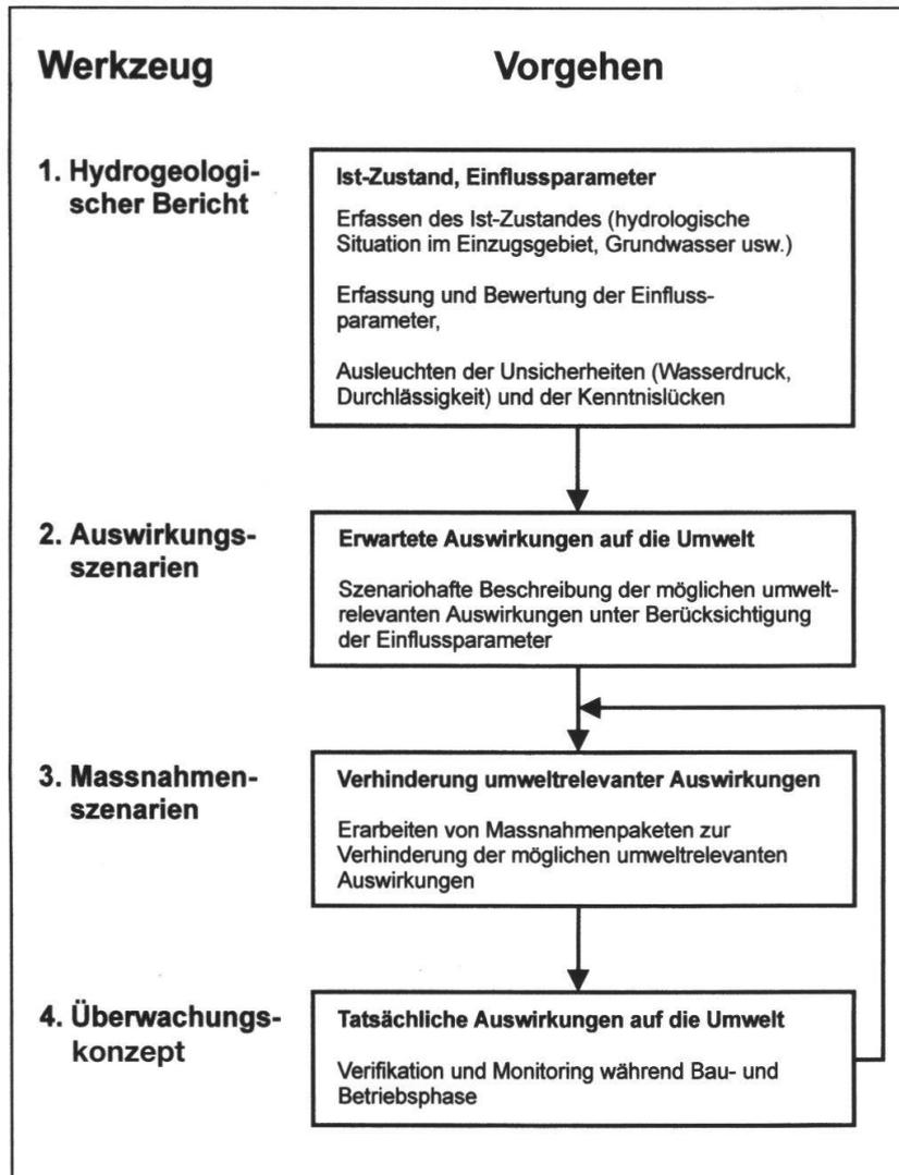
**Fig. 7:** Schematischer Ablauf der Szenarienanalyse (aus BU-WAL 1998).
