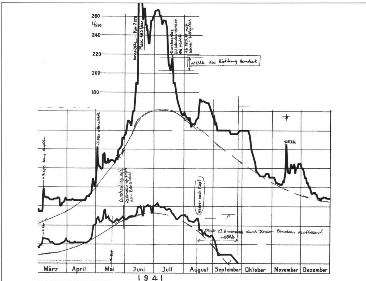
Fig. 4: Zulaufstollen Handeck-Chapf: Wasserausfluss Baufenster Benzlaur (nach Pflugshaupt & Grunder 1941).
