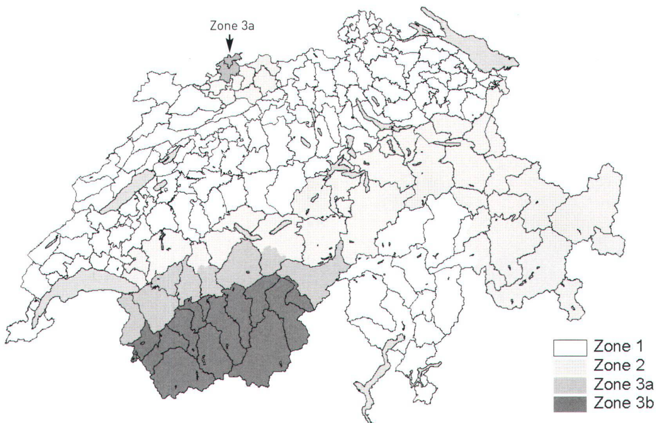
Fig. 2: Carte des zones d'aléa sismique de la Suisse selon la norme SIA 261.
