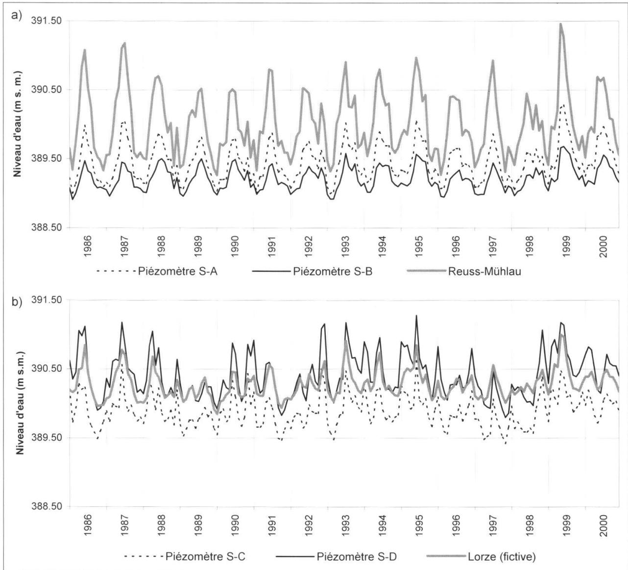
**Fig. 3:** Hydrogrammes des relevés piézométriques et hydrométriques des stations à Hünenberg. a) Zone de l'aquifère entre la Reuss et le canal de drainage, b) Zone de l'aquifère entre le canal et la Lorze.
