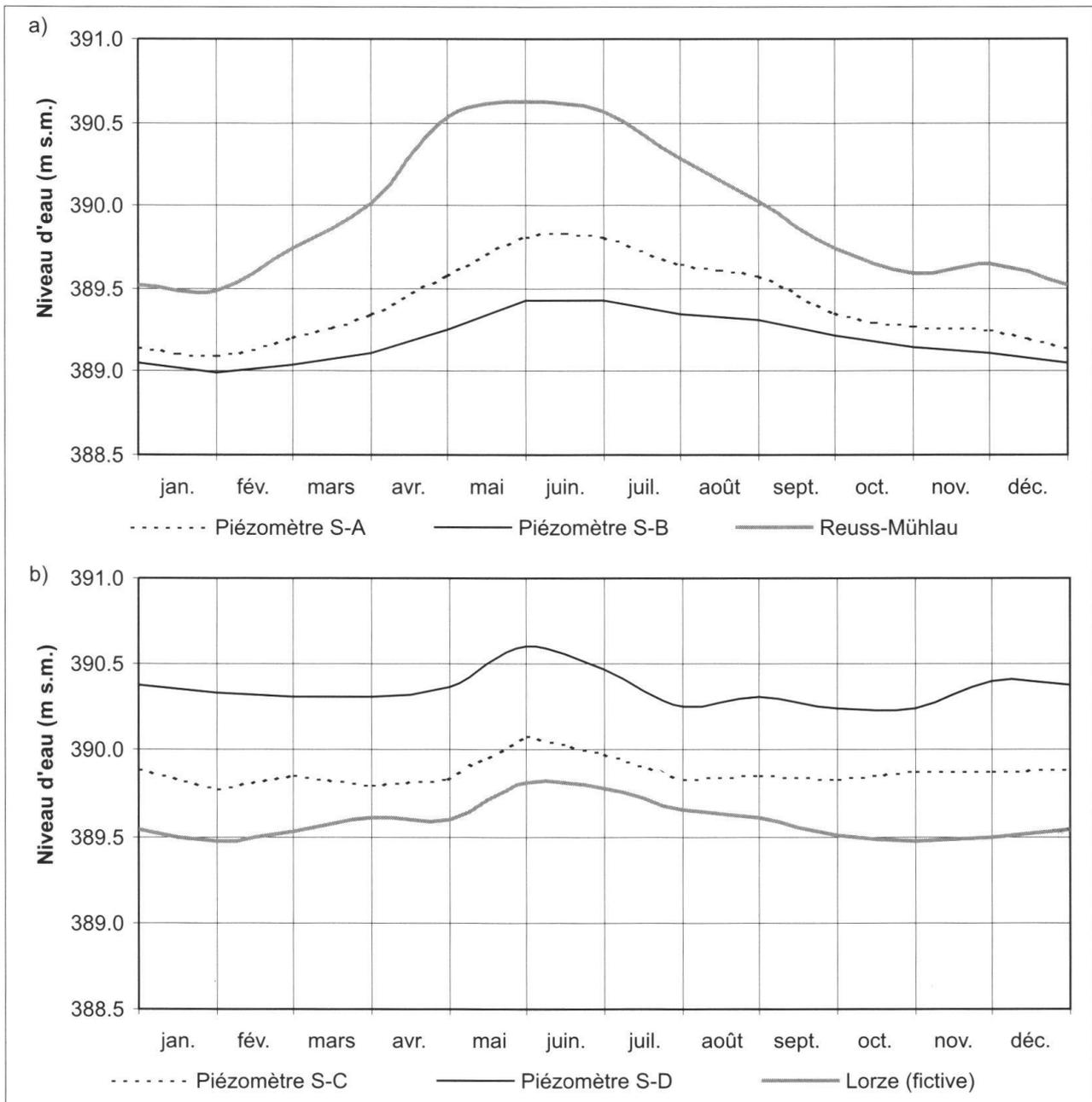
**Fig. 4:** Fréquences relatives des niveaux d'eau mensuels cotées 50% (médiane) pour la période de mesure de janvier 1986 à décembre 2000. a) Zone de l'aquifère entre la Reuss et le canal de drainage, b) Zone de l'aquifère entre le canal et la Lorze.
