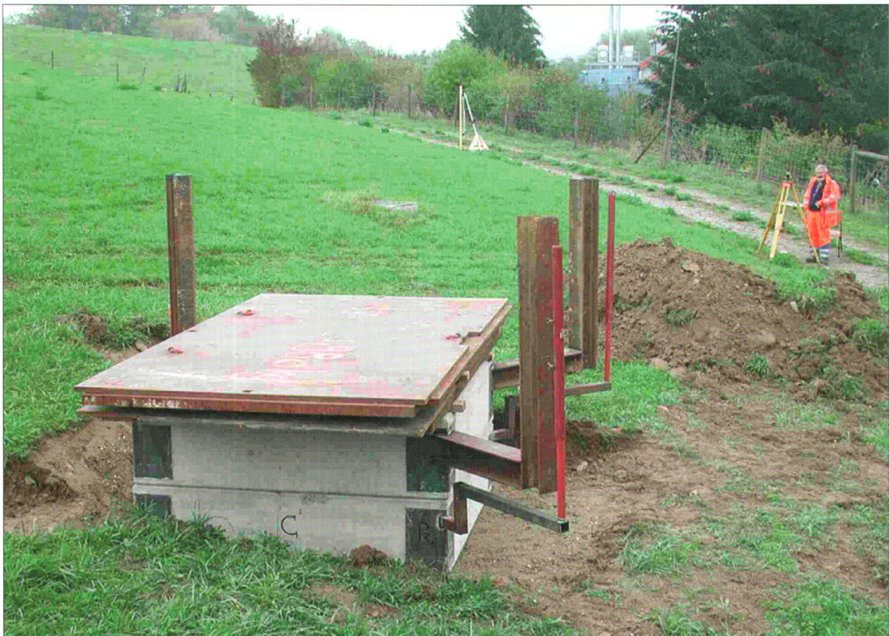
Fig. 1: Versuch Nr. 1 bei einer Last von 200 kN.
