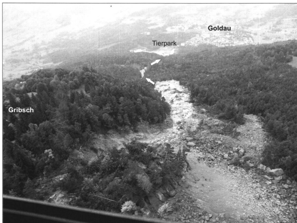
Fig. 7: Transitstrecke des murgangartig abfliessenden Schuttstroms. Dadurch wurde der zuvor geschlossene Wald auf einer Fläche von etwa 10 ha niedergewalzt (Foto: Kapo Schwyz).
