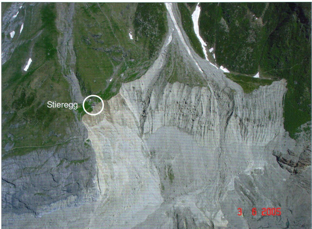
**Fig. 4:** Die grosse Rutschung Stieregg vom 29.5.2005 ( $660'000 \text{ m}^3$ ) als Folge von Erosion durch Murgänge und abschmelzendem Toteis.
