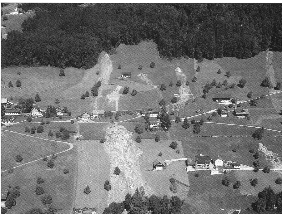
Fig. 4: Übersicht der Hangmuren im Gebiet Buochli, Ennetbürgen (Ereigniskataster Nidwalden, Foto Oeko-B AG). Die Reichweite von Hangmuren ist schwierig zu bestimmen. Es gilt zu entscheiden, wo der Übergang vom Hangmurenprozess zu Hangwasser mit Schlamm ist.
