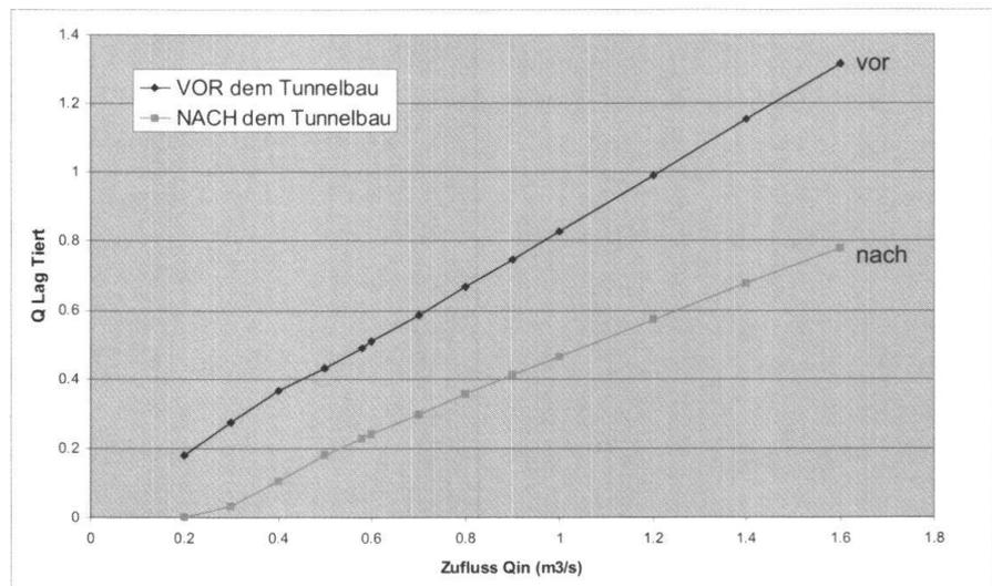
**Fig. 4:** Mit den Röhrenmodellen gerechnet: Abflussmengen (in m³/s) der Quelle aus dem Lag Tiert VOR respektive NACH dem Tunnelbau, in Relation zum Zufluss des gesamten Karstsystems.
