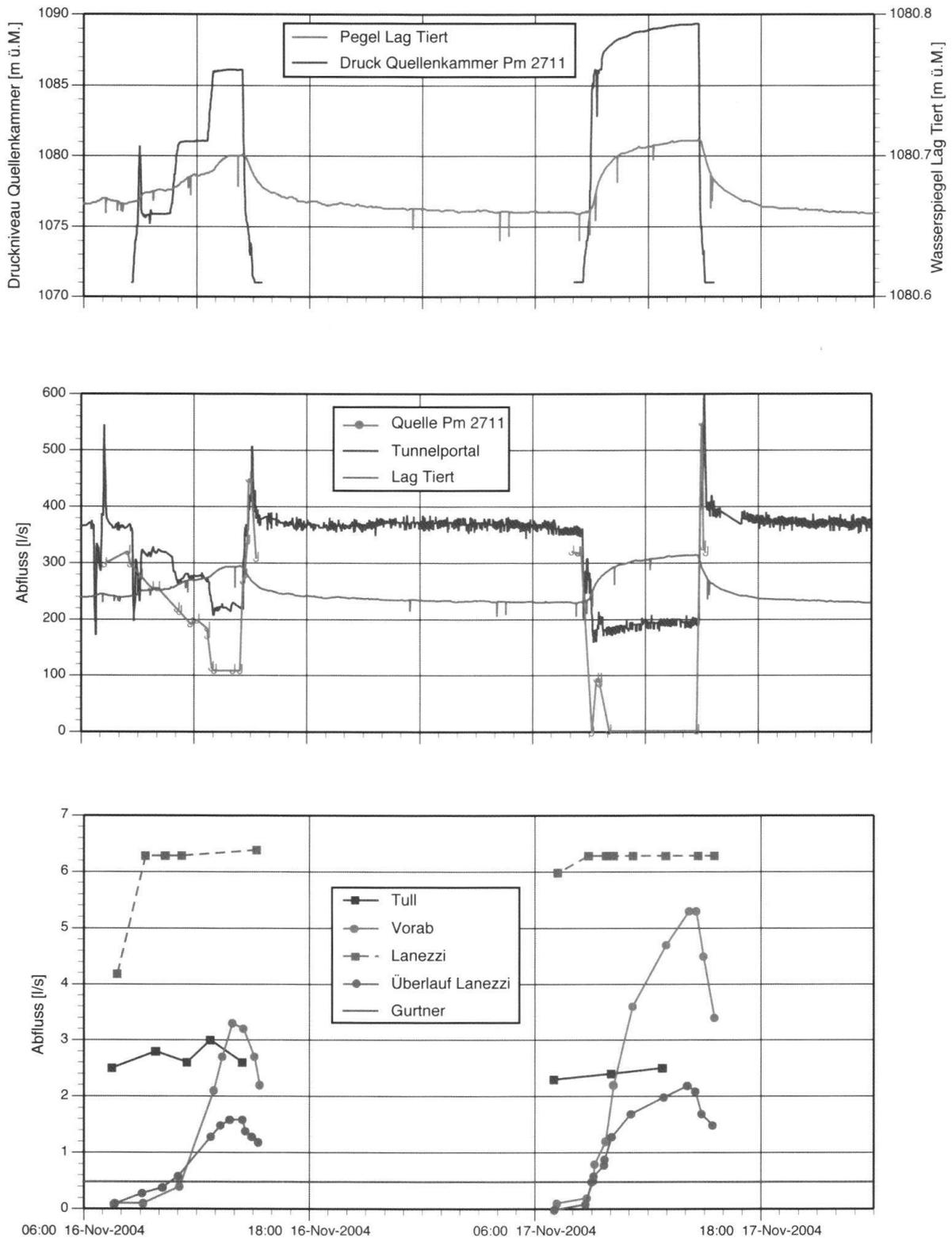
**Fig. 2:** Die im November 2004 durchgeführten Druckversuche zeigen klar, dass der Lag Tiert bei Verschluss des Tunnels stärker fliesst (obere und mittlere Grafik), und auch viele Quellen im Dorf sprechen an (untere Grafik).
