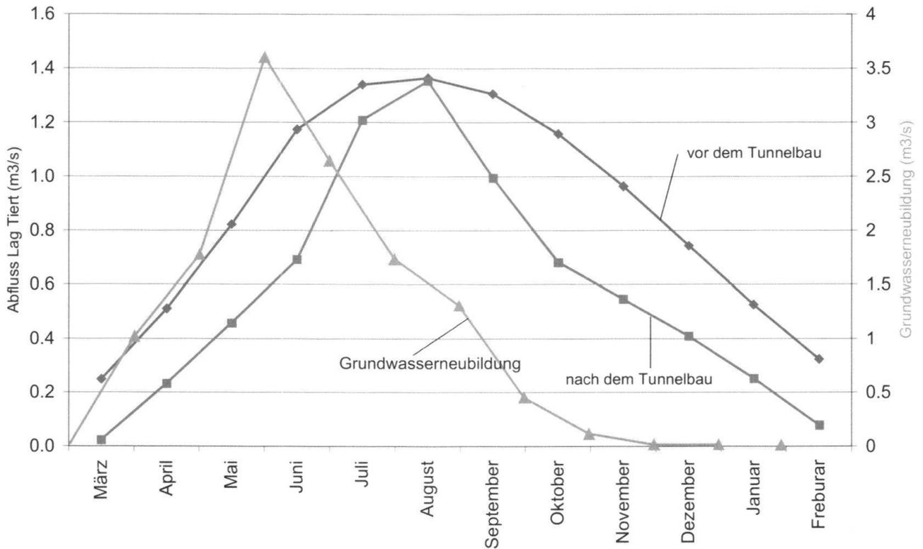
**Fig. 5:** Ergebnisse des Tankmodelles. Vor dem Tunnelbau ist der Speicher gross genug, um einen minimalen Abfluss von 200 l/s zu gewährleisten. Nach dem Tunnelbau ist der Speicher nicht mehr gross genug, um eine kontinuierliche Schüttung im Winter zu gewährleisten.
