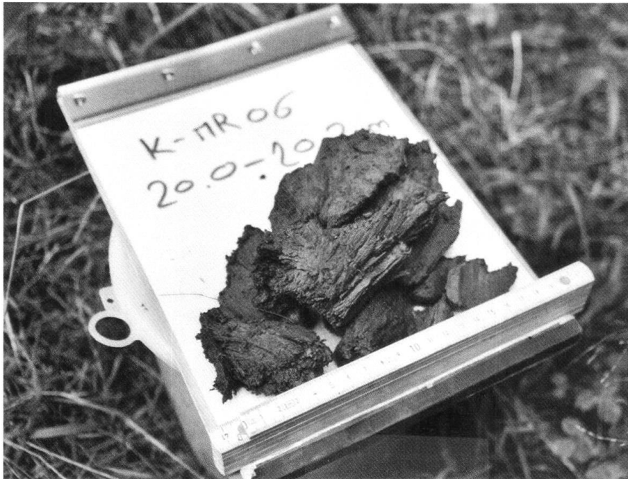
Fig. 5: Holzprobe c aus Bohrung 6 aus 20.0-20.2 m Tiefe.
