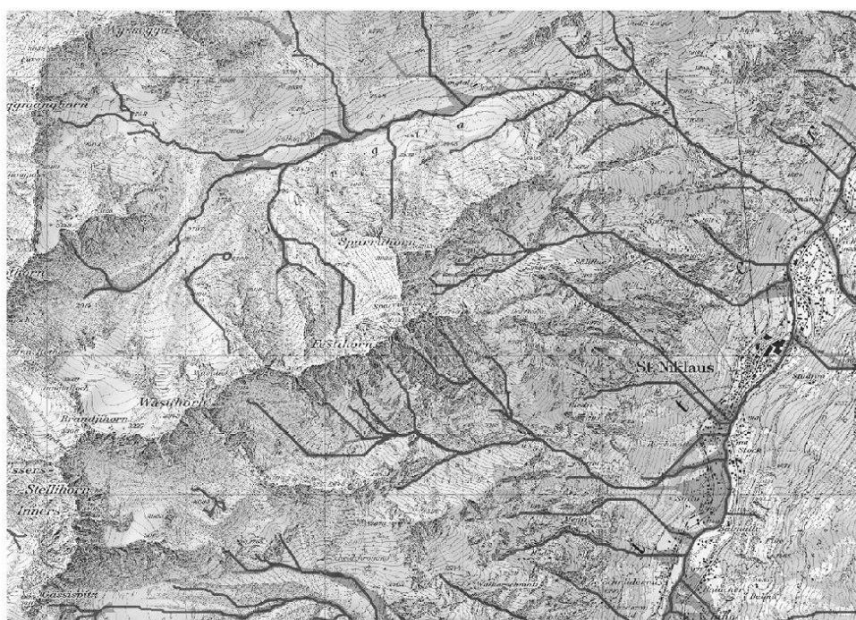
Fig. 4: Gefahrenperimeter des Prozesses Murgang. Runnennetz (dunkelgrau) und Murgangablagerungsflächen auf den Schwemmh Holzkegeln (grau).
