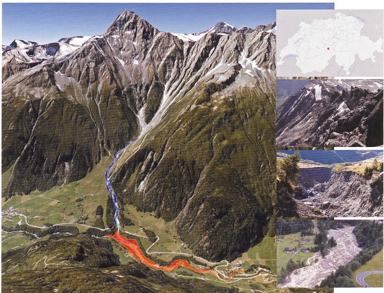
Fig. 1: Ritzlihorn mit Spreitgraben und Modellierung der bisherigen Ablagerungen in der Aare mit dem Modell RAMMS (WSL). Rechts: Illustrationen entlang des Grabens.
